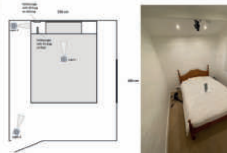
Ilustr. 2. Plan pomieszczenia pokazujący położenie urządzeń Exhale i kierunek rozpylania w nocy 1, 2 i 3 oraz lokalizację dwóch kryjówek.
