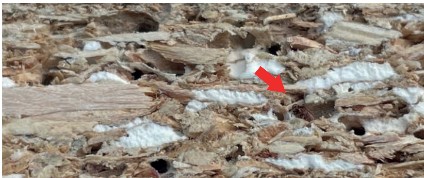
Dokładniejsza inspekcja krawędzi pozwala dostrzec otwory wyjściowe oraz chrząszcza (czerwona strzałka) i białe „popcornowe” fragmenty
