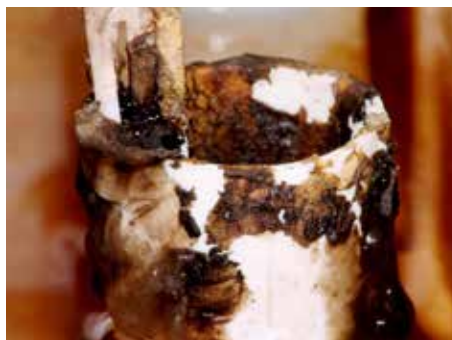
Ilustracja 5: Warstwa biofilmu na zaworze spustowym w zbiorniku spłuczki.
